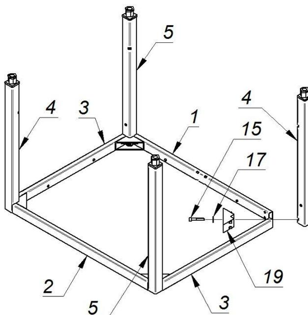
Присоедините к Стяжкам поз. 1 и 3 Ножку поз. 4 с внешней стороны и Угловой крепеж поз. 19 с внутренней стороны и стяните их друг с другом с помощью винта поз. 15 с шайбой поз. 17, не затягивая винт до конца. Остальные ножки закрепите аналогичным образом. Затяните все винты до конца.
